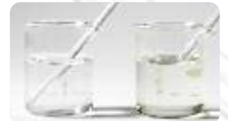
Dans le verre de droite, l'indice de réfraction de la matrice correspond à celui des charges ; dans le verre de gauche, non.
